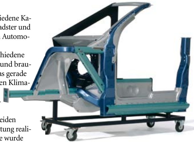
Aufgebauter Prototyp der skalierbaren Architektur
